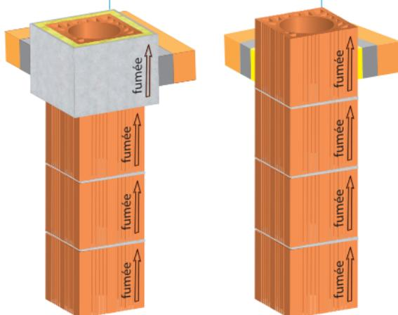
Pas de joints au niveau de la traversée des planchers.
