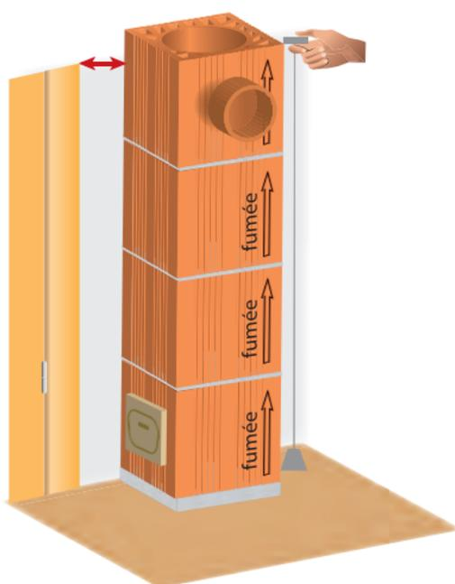
L'épaisseur des joints sera comprise entre 5 et 8 mm conformément au NF DTU 24.1 (art. 8.1.2.3)
