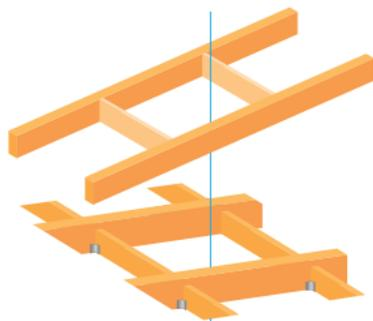
Cette étape permet de vérifier la verticalité et le passage du conduit sans obstacle au travers de la charpente, on veillera au respect de la distance de sécurité.
