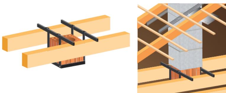
S'assurer que le plancher supporte la charge du conduit. Affleurement du boisseau en partie basse de la dalle ou de la pailleasse. Sécuriser le plancher.
