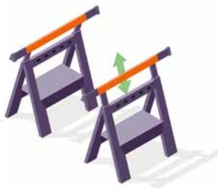
▲ Les tréteaux télescopiques permettent de régler la hauteur de travail.
