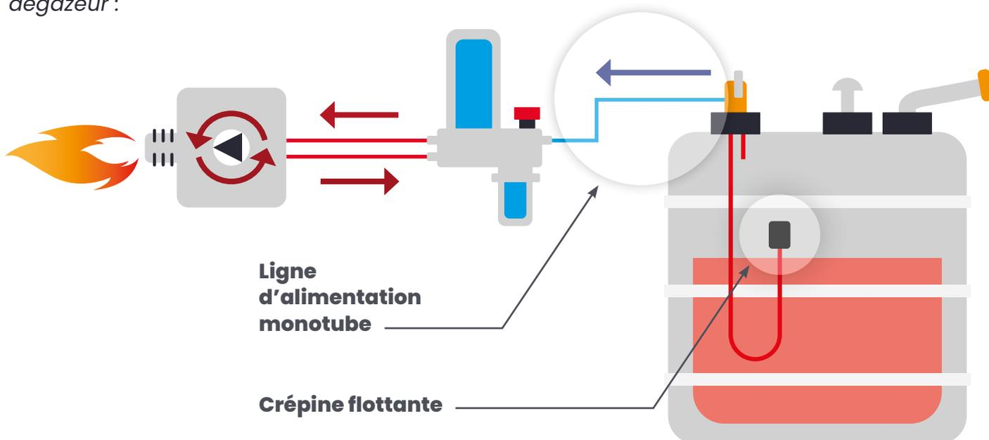
Pour l'ensemble des éléments qui constituent la ligne d'alimentation (crépine, vanne police, canalisation d'aspiration, préfiltre dégazeur, joints, clapets, raccords, ...) il s'agira de vérifier la compatibilité des matériaux, et le cas échéant de remplacer les éléments non compatibles avec le F30.
